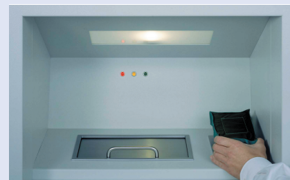
2. Einwurf tasche mit Chip identifiziert berührungslos, Schieber wird entriegelt, Signal rot/gelb
